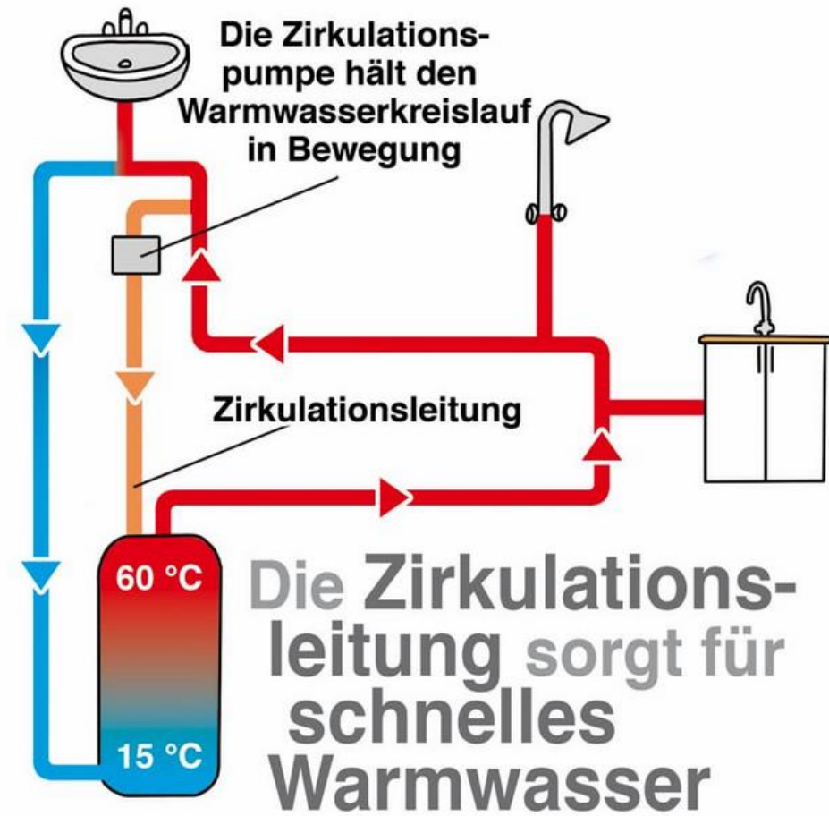
Zentrale Warmwasserbereitung mit Zirkulationsleitung
